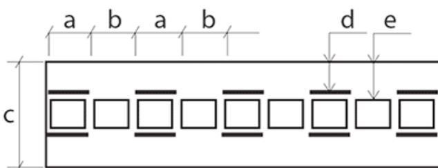
**Schéma du 35 mm avec côtes :** a = 15 mm / b = 15 mm / c = 35 mm / d = 10 mm / e = 12 mm
